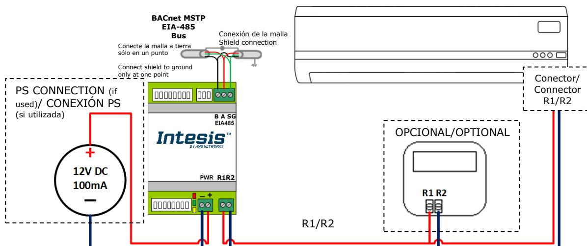
**Importante:** Si se conecta el mando del fabricante al mismo bus, la comunicación puede perderse. En caso de que esto suceda, utilice una fuente de alimentación externa conectada al conector PS del dispositivo Intesis para solventar esta situación.
